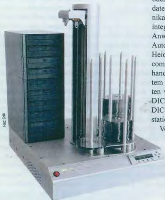
Das Robotersystem mit Steuersoftware liest Dateien von Patienten-CDs und -DVDs ein und leitet die Daten auch weiter.
